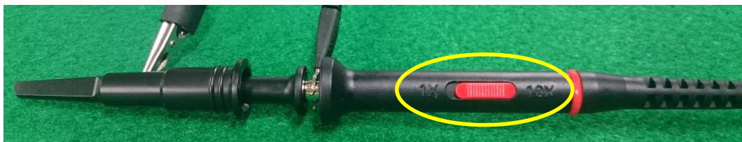
図 A-10 アッテネーターの切り替えスイッチ
