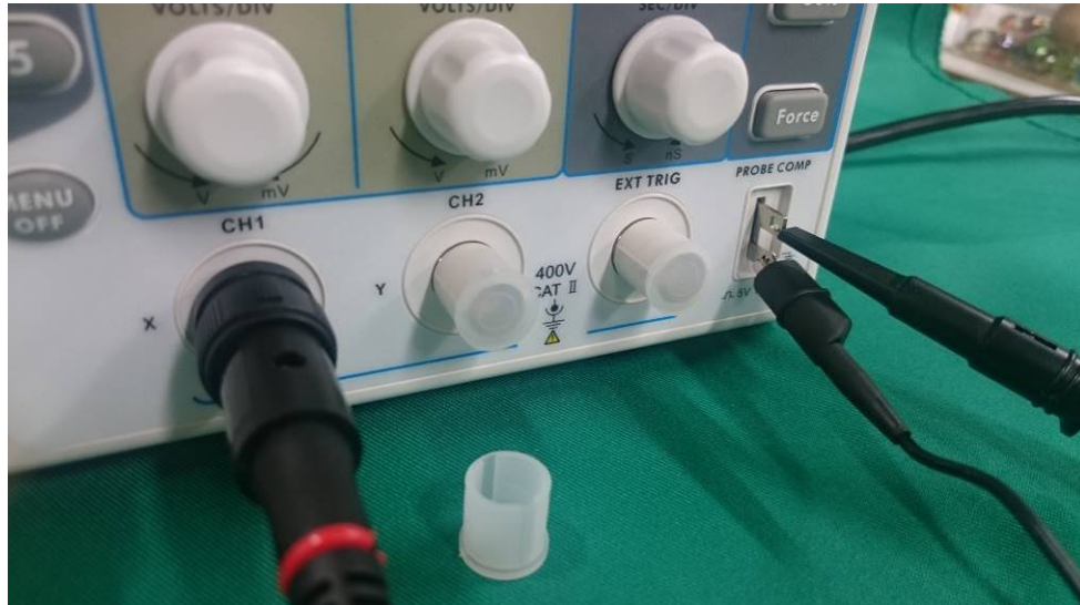
図 A-11 BNC プラグの接続とテスト信号の接続
